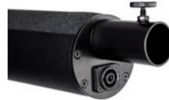
Der durchgehende U-Schacht für M6-Vierkantmuttern auf der Rückseite des Lautsprechers ermöglicht die Anbringung sämtlicher Halterungen oder eines neigbaren Stativadapters. Ein Neutrik NL4MP Speakon befindet sich auf der Bodenplatte für den Anschluss von Eingängen in mobilen Anwendungen, während sich ein Anschlussblock für feste Installationen auf der Innenseite befindet. Auf der
