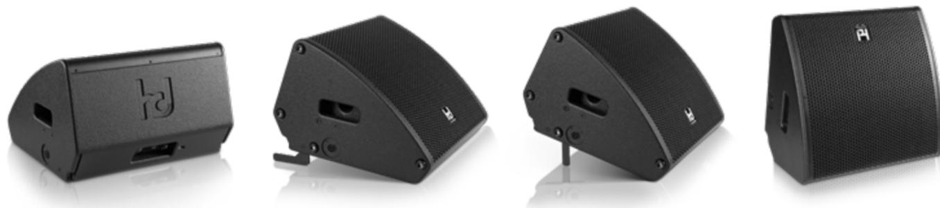
Variabel einstellbare Monitorwinkel, eine versenkte Stativhülse im Griff, Flug- und Montagepunkte, sowie ein umschaltbares Anschlussfeld machen den hd 12CXN zu einem echten Allrounder. So lässt sich im Handumdrehen der Monitorwinkel von 32° mit den integrierten, ausklappbaren Risern in zwei Stufen auf 38° oder 45° der Bühnensituation anpassen. Die Gehäuserückseite ist 15° abgeschrägt, sodass auch in der Drumfill-Anwendung der Künstler im Mittelpunkt steht.
