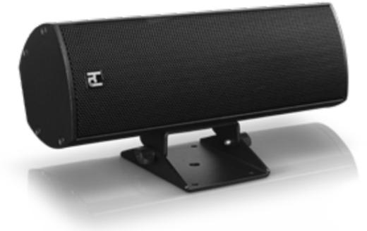
Die hd C-Serie kann flexibel und einfach installiert und montiert werden. Der Lautsprecher kann bestens mit der dezenten Kugelgelenk-Wandhalterung oder bei minimalem Platzbedarf mit L-Winkeln und zwei M6-Gewinde oben und unten ausgerichtet werden. Sollte eine Wandmontage nicht möglich sein, können die Lautsprecher mit einem 3/8"-Gewinde auf der Bodenplatte auf einem eleganten Designständer oder einem Mikrofonstativ verwendet werden.
